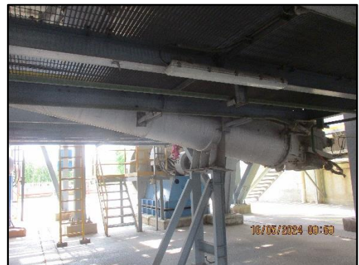
ภาพที่ 2.11 ระบบสายพานลำเลียงเข้าแบบปิดครอบ
