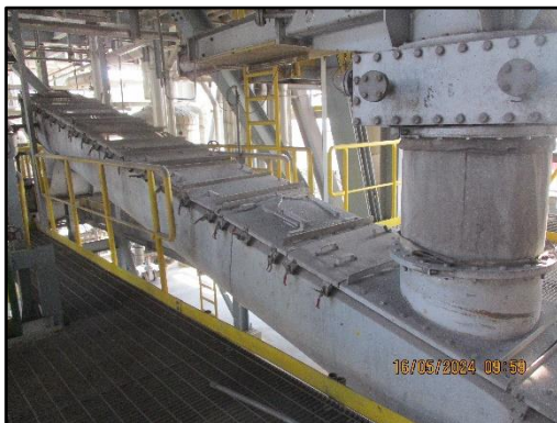
ภาพที่ 2.11 ระบบสายพานลำเลียงเข้าแบบปิดครอบ
